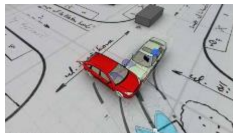
Sl.4. Mesto sudara i položaj vozila na njemu određen na osnovu lokacije oštećenja vozila i tragova na kolovozu
