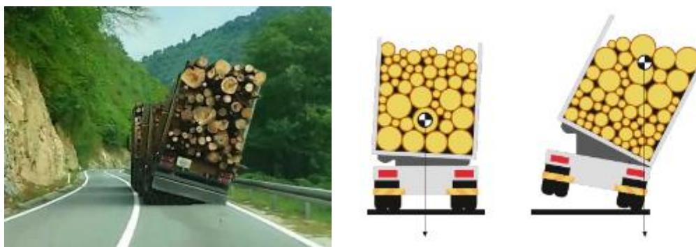
Slika 1. Primjeri prevrtanja vozila u krivini
