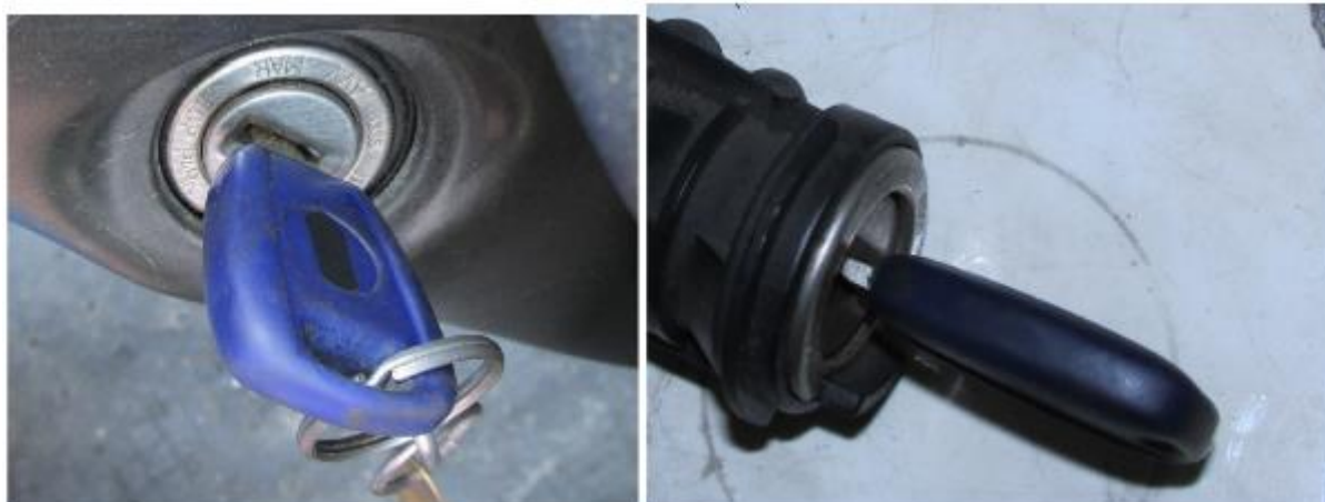
Slika 2. Ključ predmetnog vozila u položaju STOP. Na bravi upravljača predmetnog vozila cilindar je iskočio i volan se zaključao (levo). Na ispravnoj uporednoj bravi upravljača cilindar je ostao malo uvučen i volan neće biti zaključan dok se ključ ne izvadi iz brave upravljača (desno).
