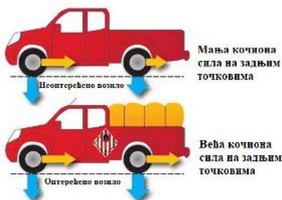
Слика 7. Расподела кочних сила на возилу без и са оптерећењем [7]
