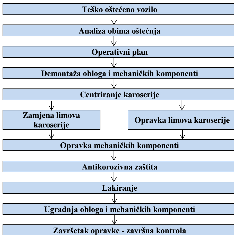
Dijagram 1. Proces popravke oštećenog vozila
