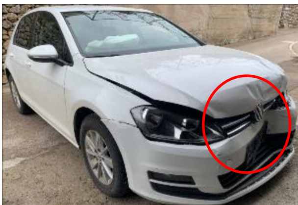
Primjer 1. Zona neposrednog udara: zgužvani limovi, slomljene komponente
