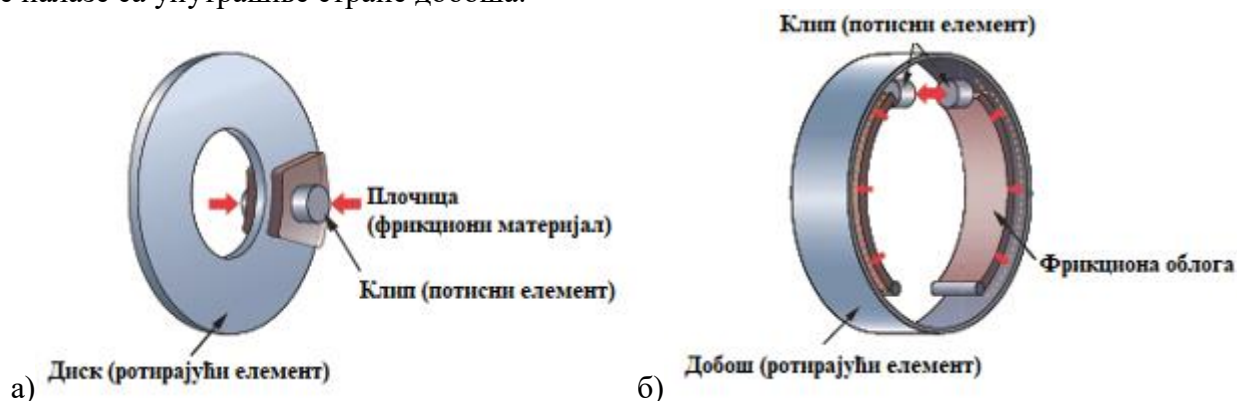
Слика 2. Постојећи кочних механизма, где је а) диск кочни механизам б) добош кочни механизам
